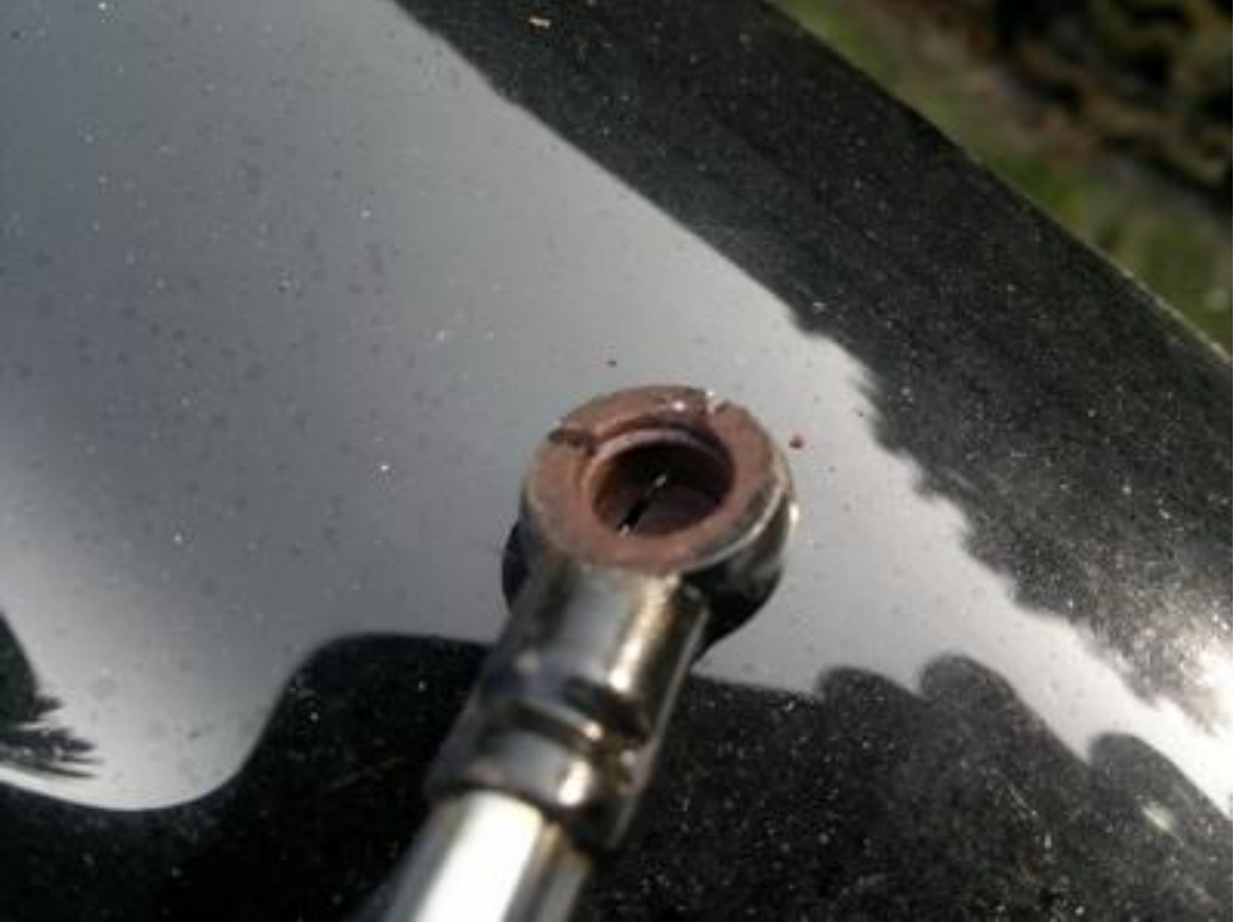
Foto5: De (spring)veer in de gasveerkop die de kogel afklemt
